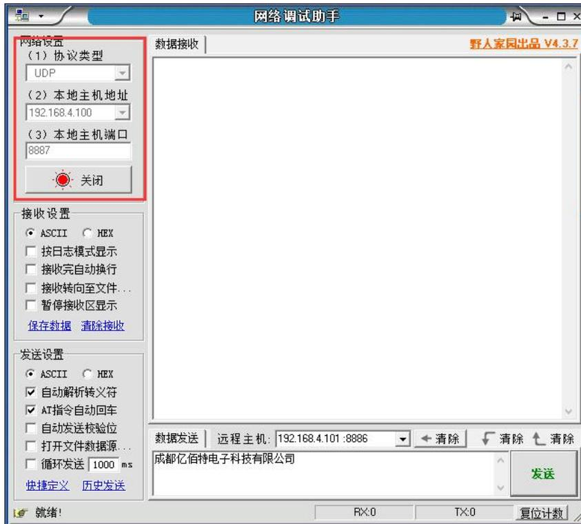
2、将设备 SOCKET A1 网络类型设置为 UDPC（UDP Client），目标 IP 为 192.168.4.100，目标端口 8887。点击保存，重启模块。
