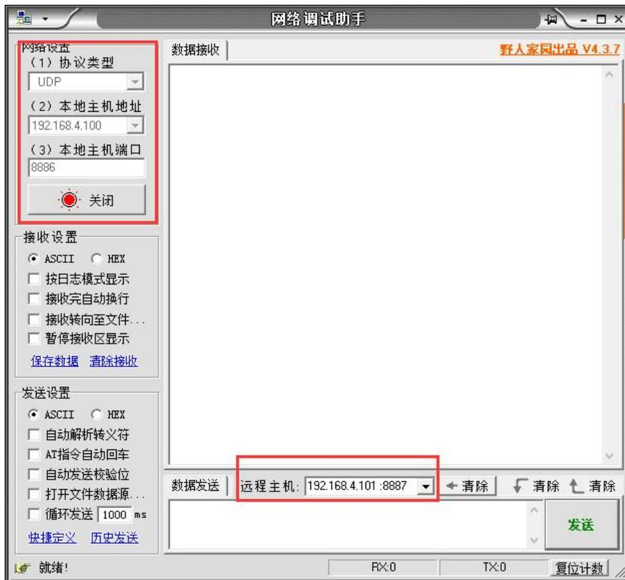
2、将设备 SOCKET A1 网络类型设置为 UDPS (UDP Server)，本地 IP 为 192.168.4.101，本地端口 8887。点击保存，重启模块。
