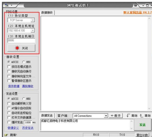
2、将设备 SOCKET A1 网络类型设置为 TCPC (TCP Client)，目的 IP 为 192.168.4.100，本地端口 0 (随机端口)，目
