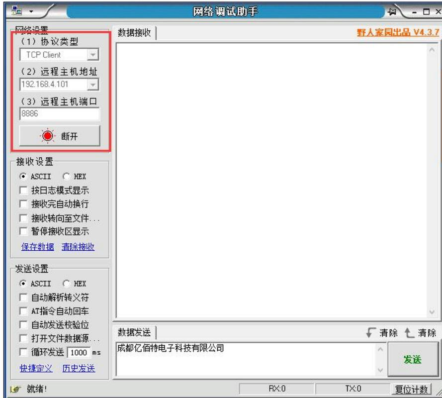
2、将设备 SOCKET A1 网络类型设置为 TCPS (TCP Server)，本地端口 8886。点击保存，重启模块。
