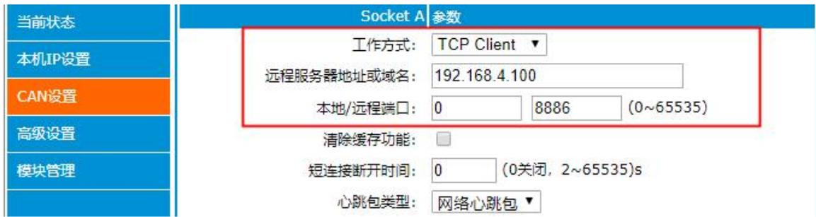
3、打开 CAN 分析仪软件，选择正确 COM 口和波特率，待设备连接上 TCP Server，与“网络调试助手”进行通信测试。
